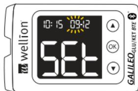
Schritt 5: Einstellen des Jahres: Das aktuell eingestellte Jahr blinkt. Wählen Sie das korrekte Jahr mit Hilfe der Pfeiltasten. Bestätigen Sie Ihre Wahl durch Drücken der OK-Taste und fahren Sie mit dem Einstellen der Stunden fort.
