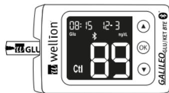
Schritt 7: Vergleichen Sie das Ergebnis auf der Anzeige mit dem Kontrolllösungsbereich, der auf der Teststreifendose aufgedruckt ist. Ist das Ergebnis außerhalb dieses Bereiches, sehen Sie im Kapitel „Kontrolllösung Problembehebung“ nach.
