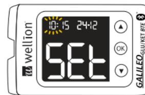
Schritt 7: Einstellen der Minuten: Die aktuell eingestellten Minuten blinken. Wählen Sie die korrekten Minuten mit Hilfe der Pfeiltasten. Bestätigen Sie Ihre Wahl durch Drücken der OK Taste und das von Ihnen korrigierte Datum und die Uhrzeit blinken.
