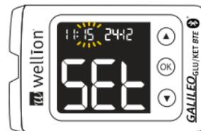
Wählen Sie mit Hilfe der Pfeiltasten die nächste Funktion im Einstellungs Menü aus, oder führen Sie einen Teststreifen ein, um eine Messung durchzuführen. Sie können das Gerät auch ausschalten, indem Sie die OK Taste drücken und halten, bis am Bildschirm OFF erscheint.
