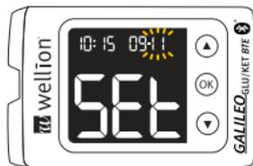
Schritt 4: Einstellen des Tages: Der aktuell eingestellte Tag blinkt. Wählen Sie den korrekten Tag mit Hilfe der Pfeiltasten aus. Bestätigen Sie Ihre Wahl durch Drücken der OK-Taste und fahren Sie mit dem Einstellen des Jahres fort.
