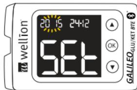
Schritt 6: Einstellen der Stunden: Die aktuell eingestellte Stunde blinkt. Wählen Sie die korrekte Stunde mit Hilfe der Pfeiltasten. Bestätigen Sie Ihre Wahl durch Drücken der OK Taste und fahren Sie mit dem Einstellen der Minuten fort.
