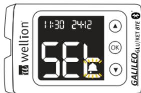
Schritt 3: Auf der Anzeige blinken „Glu“ oder „Ket“. Um den Alarm für Glukose einzustellen, wählen Sie GLU mit Hilfe der Pfeiltasten und drücken Sie die OK Taste. Um den Alarm für Ketone einzustellen, wählen Sie KET mit Hilfe der Pfeiltasten und drücken Sie die OK Taste.
