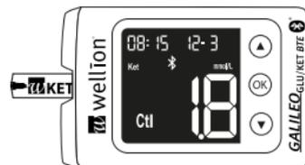
Schritt 7: Vergleichen Sie das Ergebnis auf der Anzeige mit dem Kontrollbereich, der auf der Teststreifenpackung zu finden ist. Fällt das Ergebnis nicht in den Kontrollbereich, sehen Sie im Kapitel „Kontrolllösung Problembehebung“ nach.
