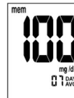
3. Schritt: Drücken Sie die ▼ Taste, um zu den Tagesdurchschnittswerten zu gelangen. Als Erstes wird der Durchschnittswert von 7 Tagen angezeigt. Drücken Sie wiederholt die ▼ Taste um auch die Durchschnittswerte von 14 und 30 Tagen anzusehen. Sobald der Durchschnittswert von 30 Tagen angezeigt wird, können Sie die ▲ Taste drücken um zurück zu den Tagesdurchschnittswerten und in den Speicher zu gelangen.
