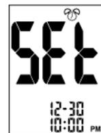
3. Schritt: Drücken Sie die ▼ ▲ Pfeiltasten bis am Display das Alarm Symbol blinkt.
