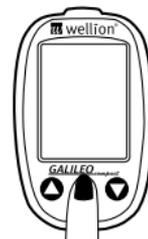
2. Schritt: Beim Loslassen der OK Taste führt das Messgerät eine automatische Systemkontrolle durch. "☺" erscheint am Display und Sie befinden sich im Hauptmodus.
