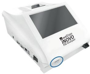
Schieben Sie den Kalibrierungscodechip ("ID card") des Testkits in den Chip-Einschub des Analyzers ein.
