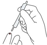
Saugen Sie 20 µl Probe (kapilläres / venöses Vollblut; Plasma oder Serum), mit der 20 µl-Pipettenspitze (Einprägung) auf.
